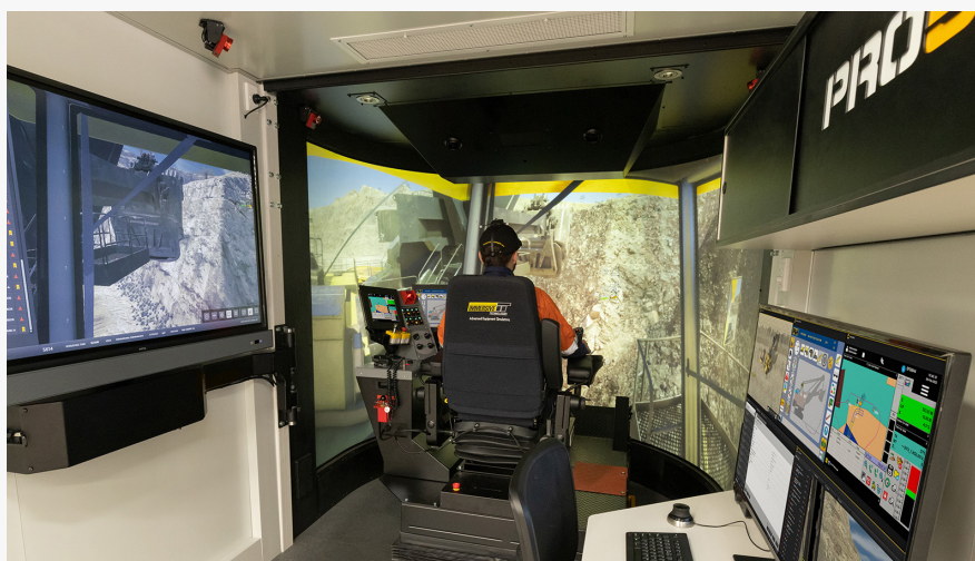
PRO5 — усовершенствованный симулятор оборудования (Advanced Equipment Simulator), оснащенный стереоскопическим 3D-дисплеем и системой визуализации профессионального уровня
